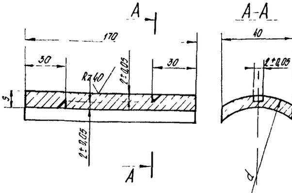
Рис.1. Испытательный образец для настройки дефектоскопа тепловых электростанций\* ОП №501 ЦД-75 (М.: СПО Советэнерго, 1978). Допускается изготавливать искусственные отражатели электроэрозионным методом.
