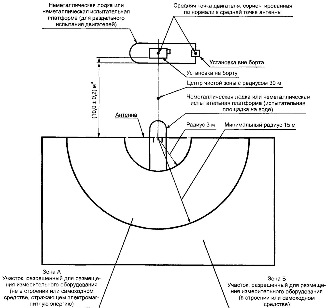
Примечание - Расстояние по горизонтали измеряется от центра диполя до ближайшей части установки на воде (или двигателя, если он испытывается отдельно)
