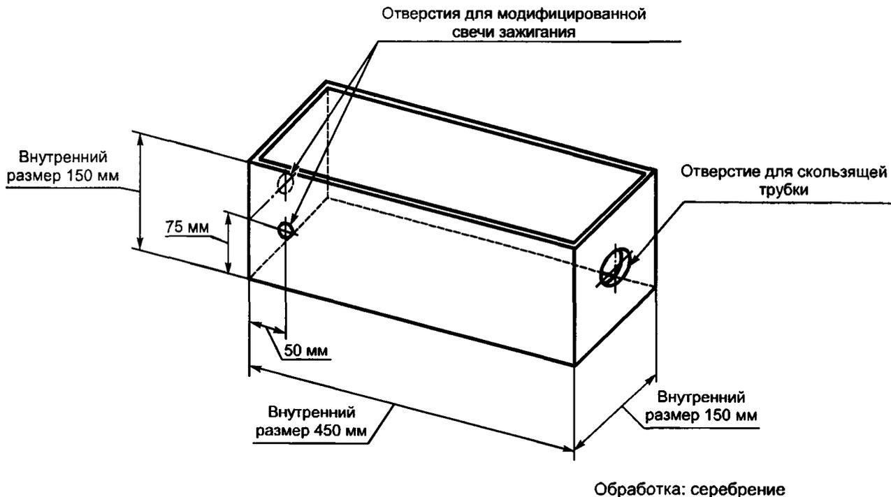
Рисунок В.4 — Размеры испытательного контейнера
