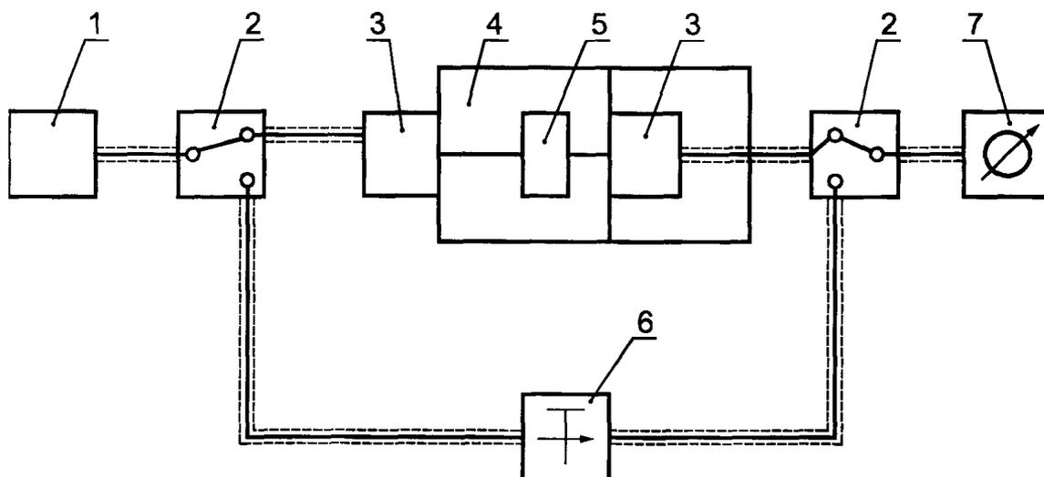
1 — генератор сигналов, 2 — коаксиальный переключатель, 3 — фиксированный Т-аттенюатор (10 дБ), 4 — испытательный контейнер, 5 — испытуемый образец, 6 — откалиброванный регулируемый аттенюатор, 7 — измерительный прибор
