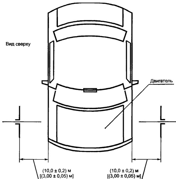
Рисунок 6 — Расположение антенны при измерении ИРП — горизонтальная поляризация
