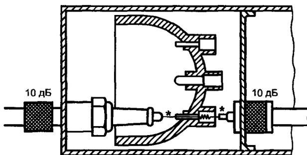
Рисунок В 9 — Помехоподавляющее устройство в крышке распределителя
