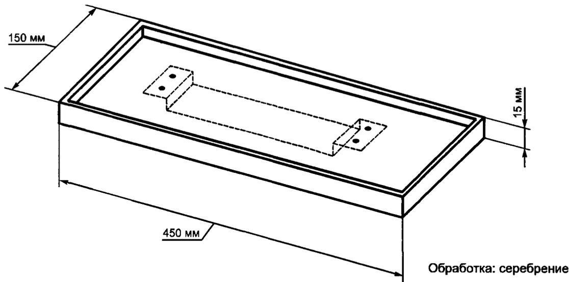
Примечание — Крышка изготовлена так, чтобы обеспечить при надевании на верхнюю часть испытательного контейнера U-образное перекрытие
