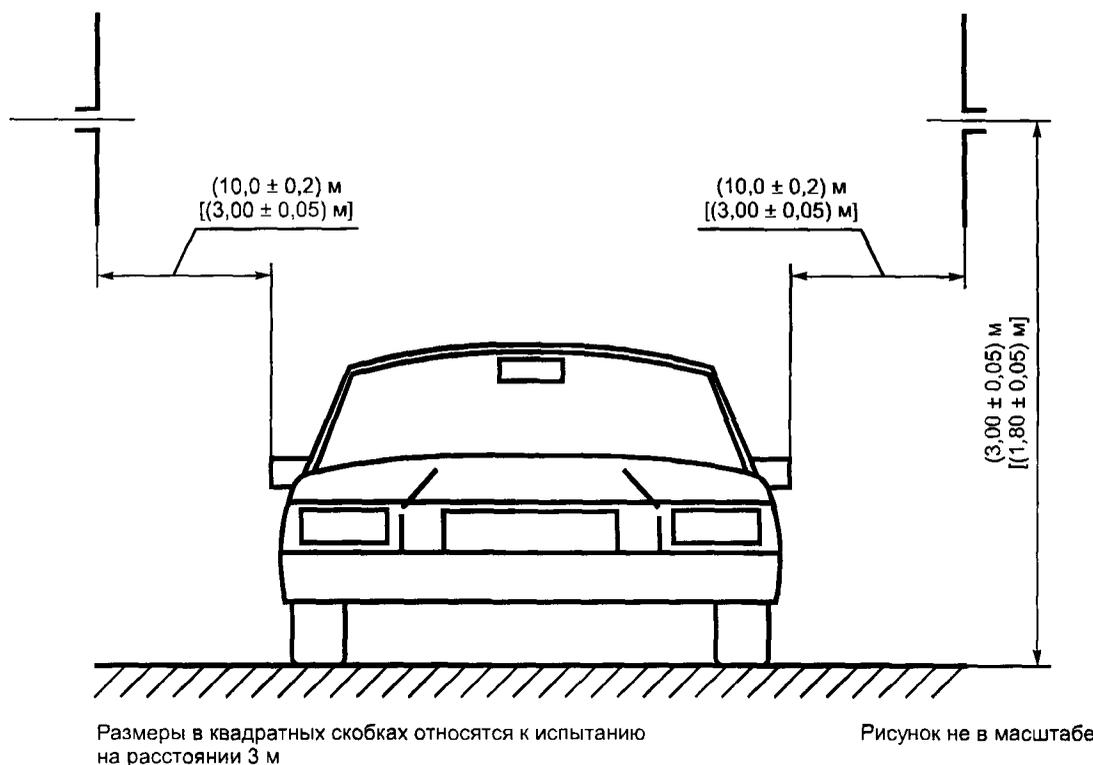
Рисунок 5 — Расположение антенны при измерении ИРП — вертикальная поляризация
