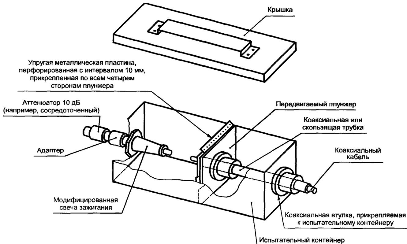
Рисунок В 2 — Общий вид испытательного контейнера
