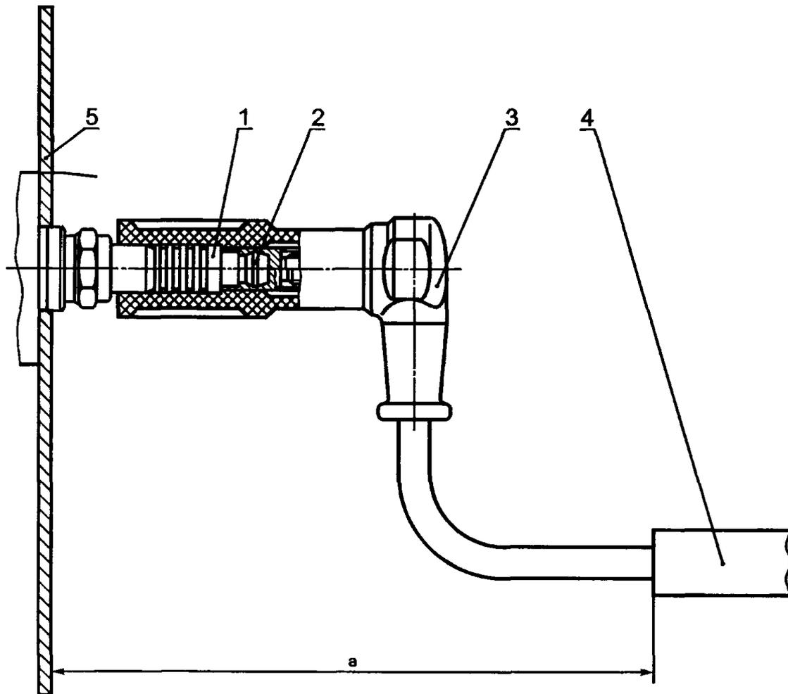
1 — искровой зазор обеспечивается свечой зажигания для измерения в соответствии с Г 5,
