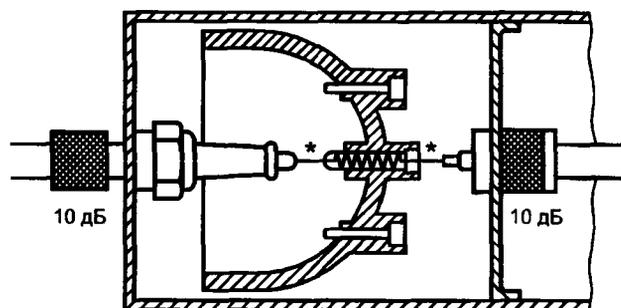
Рисунок В 8 — Резистивная контактная щетка распределителя
