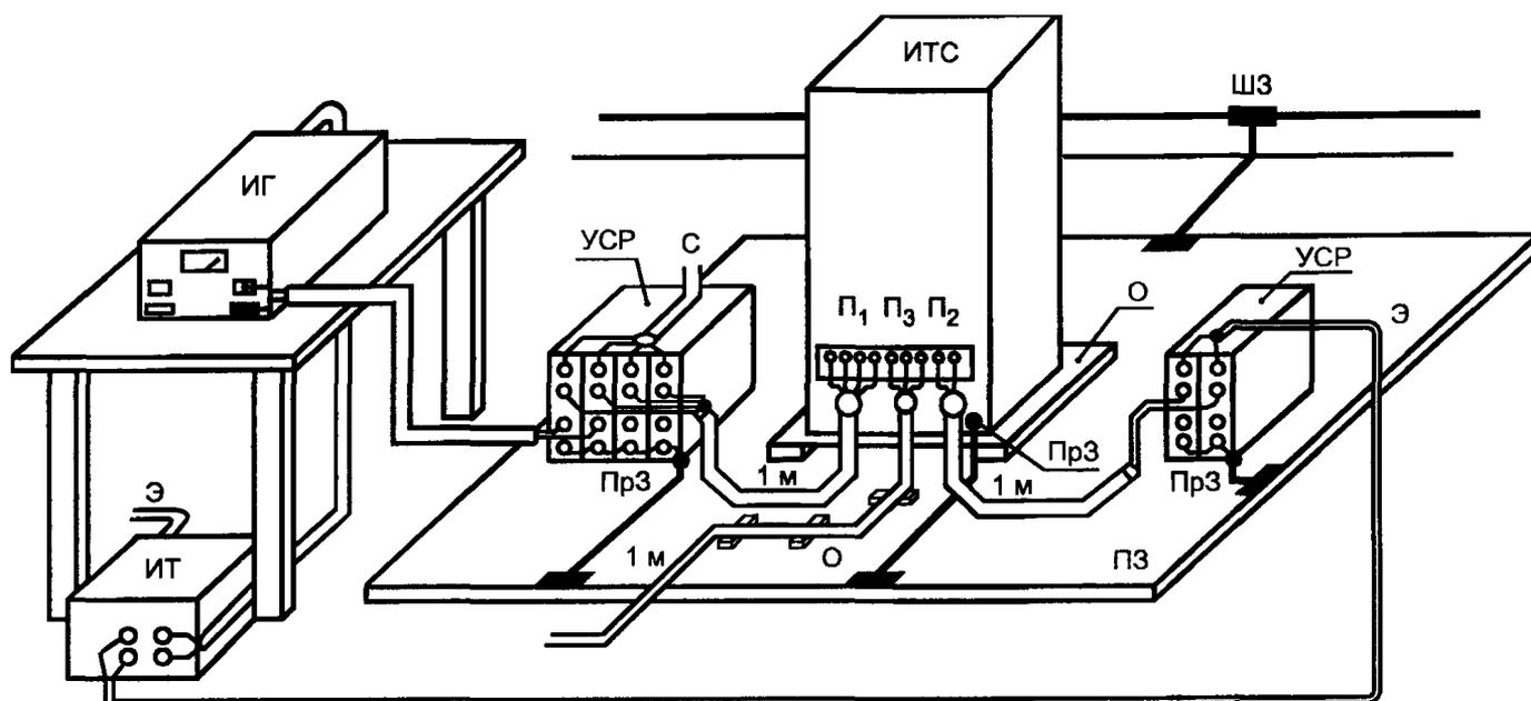
ШЗ — шина защитного заземления; Э — к сети электропитания; П<sub>1</sub> — порт ввода-вывода; П<sub>2</sub> — порт электропитания; П<sub>3</sub> — порт связи; С — к источнику сигналов; ПрЗ — проводник заземления; ПЗ — пластина заземления; УСР — устройство связи/развязки; О — изоляционная опора; ИТ — изолирующий трансформатор
