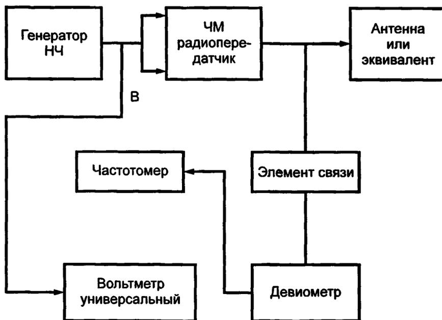
Рисунок 1 — Схема измерений параметров систем стереофонического радиовещания
