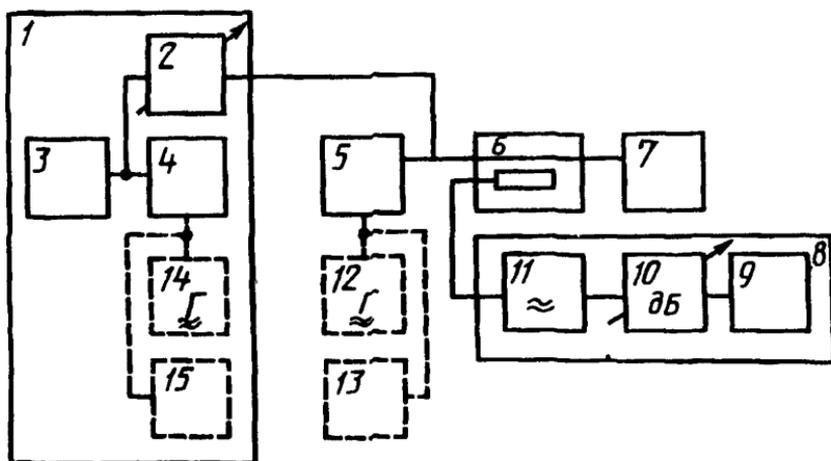
1, 8 — экранированные камеры, 2 — устройство регулируемой связи, 3, 7 — эквивалентные нагрузочные сопротивления, 4 — дополнительный радиопередатчик, 5 — контролируемый радиопередатчик, 6 — направленный ответвитель, 9 — измерительный приемник, 10 — аттенуатор, 11 — фильтр, 12, 14 — генераторы сигналов низкочастотные, 13, 15 — вольтметры переменного тока
