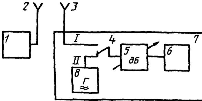
1 — контролируемый радиопередатчик; 2 — антенно-фидерная система;
