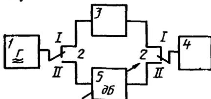
1 — измерительный генератор; 2 — высокочастотный переключатель;
