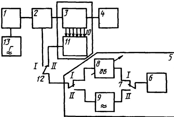
1 — контролируемый передатчик; 2 — направленный ответвитель для волны основного типа; 3 — НОММ или отборник другого типа; 4 — эквивалентное нагрузочное сопротивление или штатная антенна радиопередатчика; 5, 10 — экранированные камеры (используются при необходимости); 6 — измерительный приемник; 7, 12 — высокочастотный переключатель; 8 — измерительный аттенюатор; 9 — фильтр (используется при необходимости); 11 — многоканальный коаксиальный переключатель; 13 — генератор сигналов низкочастотный
