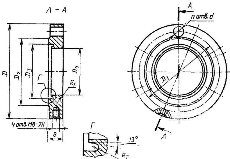
Примечание. Необходимость изготовления отверстий М8—7Н для крепления кожуха оговаривается при заказе.
