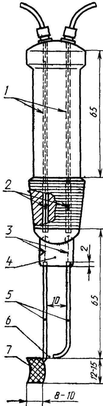
1 — изоляция для муфты; 2 — твердый спай медной проволоки, диаметром 0,7 мм; 3 — вольфрамовая проволока, диаметром 1 мм; 4 — зажимное устройство; 5 — платиновая проволока, диаметром 16 мм; 6 — зазор 2 мм; 7 — держатель образца (корзинка из платиновой проволоки, толщиной 0,5 мм)
