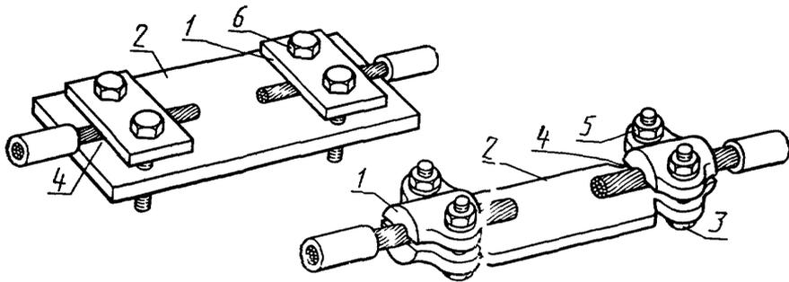
1 — седлообразная пластина; 2 — неподвижная часть; 3 — шпилька; 4 — место проводника; 5 — гайка; 6 — винт
