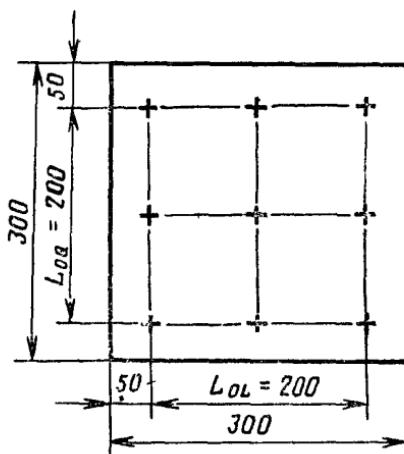
$L_{OQ}$  — расстояние между метками в направлении утка до мокрой обработки, мм;  $L_{OL}$  — расстояние между метками в направлении основы до мокрой обработки, мм
