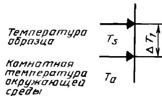
**Стадия 1.** Образец находится под нагрузкой. Испытание в условиях лаборатории без принудительной циркуляции воздуха. Измерение температуры образца.
