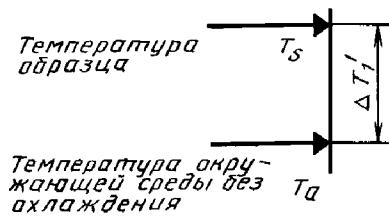
**Стадия 2.** Образец находится под нагрузкой. Испытание в условиях камеры при наличии принудительной циркуляции воздуха и отсутствии охлаждения образца. Разность  $\Delta T_1 - \Delta T_1'$  должна быть мала.
