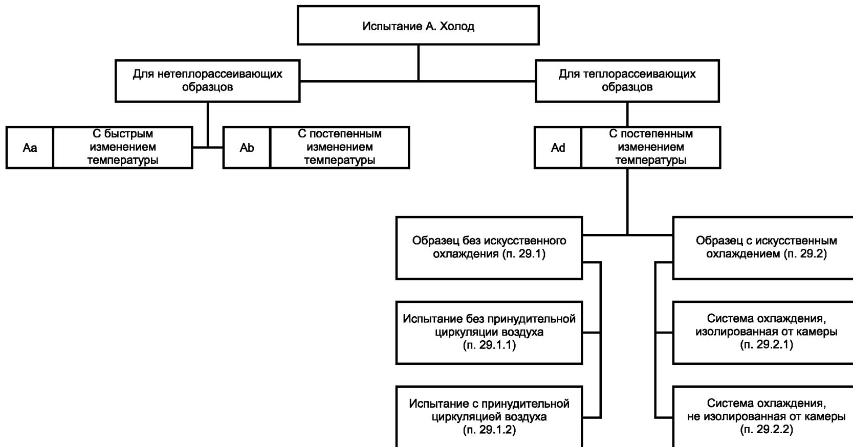
**Блок-схема испытания А: Холод, показывающая идентичность
