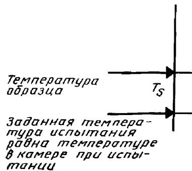
**Стадия 3.** Образец находится под нагрузкой. Испытание в условиях камеры при наличии принудительной циркуляции воздуха и охлаждения образца. Контроль ведется по заданной температуре окружающей среды.
