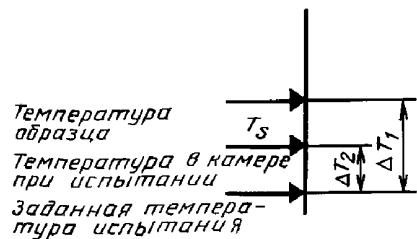
**Стадия 2.** Образец находится под нагрузкой. Испытание в камере при наличии принудительной циркуляции воздуха. Контроль при температуре образца ( $\Delta T_2$  должно быть мало). Измерение температуры испытательной камеры проводят, как указано в п. 4 МЭК 68-1, п. 4 (ГОСТ 28198).
