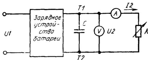
$U_1$  — напряжение питания;  $U_2$  — выходное напряжение;  $I_2$  — выходной ток;  $C$  — конденсатор;  $A$  — амперметр;  $V$  — вольтметр;  $R$  — регулируемое сопротивление;  $T_1$  и  $T_2$  — зажимы или клеммы выходного контура зарядного устройства батареи, например зажим батареи
