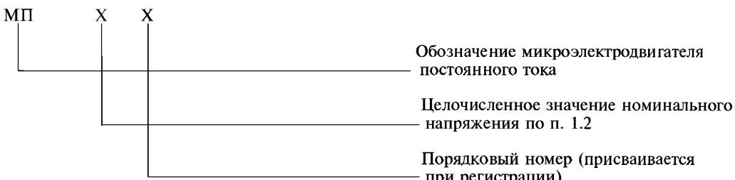
Пример условного обозначения микроэлектродвигателя постоянного тока с номинальным напряжением 2,4 В, с порядковым номером 14:
