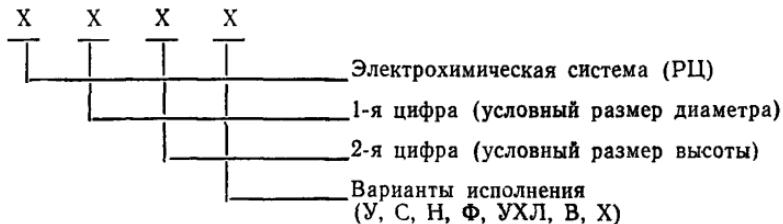
Не допускается элементам различного исполнения с одинаковыми габаритами присваивать различные цифровые обозначения.
