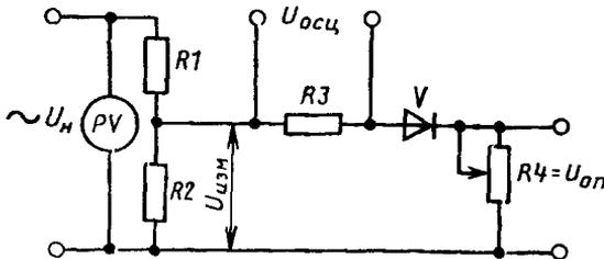
$R1, R2, R3$ —безындукционные резисторы  $R4$ —резистор,  $V$ —диод,  $U_n$ —номинальное напряжение  $U_{изм}$ —измеряемое напряжение,  $U_{оп}$ —постоянное опорное напряжение  $U_{осц}$ —амплитудное значение напряжения на входе осциллографа ( $U_{мосц} > U_{оп}$ ),  $PV$ —вольтметр
