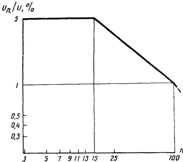
$n$ —порядок гармонической составляющей.  $U_n$ —действующее значение напряжения гармоники порядка  $n$ .  $U$ —действующее значение номинального переменного напряжения на входе
