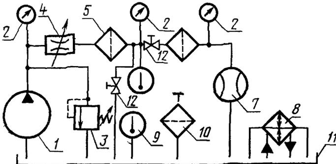
1—насос; 2—манометр; 3—предохранительный гидроклапан; 4—дрозель;
