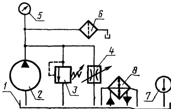
1—гидробак; 2—насос; 3—предохранительный гидроклапан; 4—дрогель; 5—манометр; 6—испытываемый фильтр; 7—термометр; 8—теплообменный аппарат
