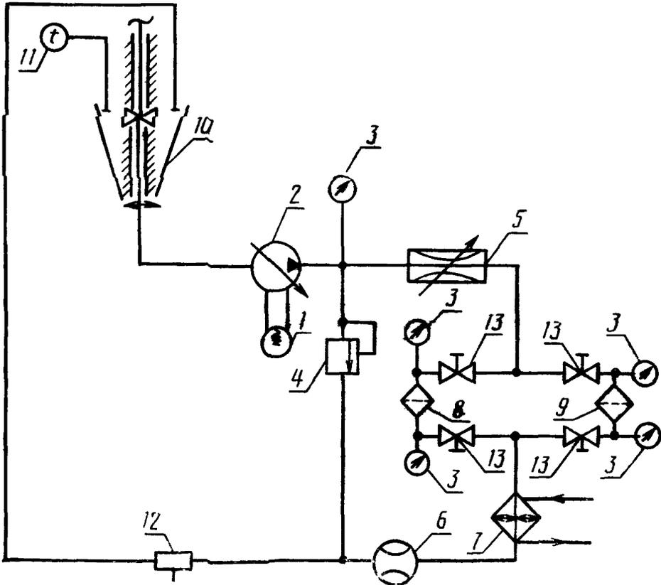
1 — электродвигатель, 2 — гидронасос; 3 — манометр; 4 — предохранительный клапан, 5 — дроссель, 6 — расходомер; 7 — теплообменник; 8 — испытуемый фильтр, 9 — технологический фильтр, 10 — бак; 11 — термометр, 12 — пробоотборник, 13 — вентиль
