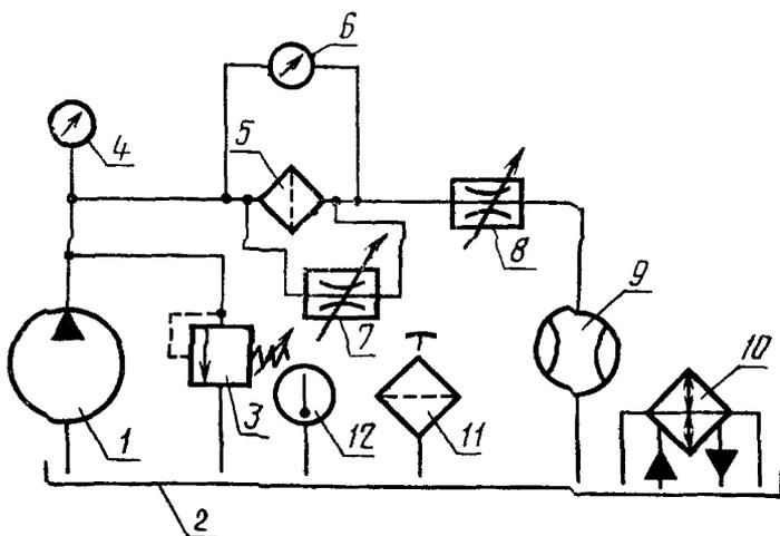
1—насос; 2—гидробак; 3—предохранительный гидроклапан; 4—манометр; 5—испытываемый фильтр; 6—дифманометр; 7—дрогель; 8—дрогель; 9—расходомер; 10—теплообменный аппарат; 11—сапун; 12—термометр
