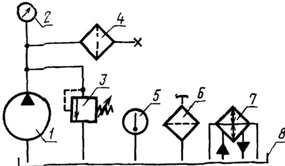
1—насос, 2—манометр, 3—предохранительный клапан;
