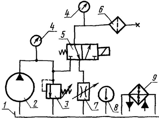
1—гидробак; 2—насос; 3—предохранительный клапан;
