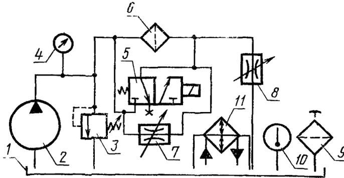
1—гидробак; 2—насос; 3—предохранительный клапан;
