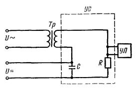
U — источник переменного напряжения; U — источник постоянного напряжения; Tp — высоковольтный трансформатор; R — ограничительный резистор; C — разделительная емкость, 1 — 5 мкф; y y — устройство совмещения постоянной и переменной составляющих; y I — устройство для под-ключения испытуемого объекта
