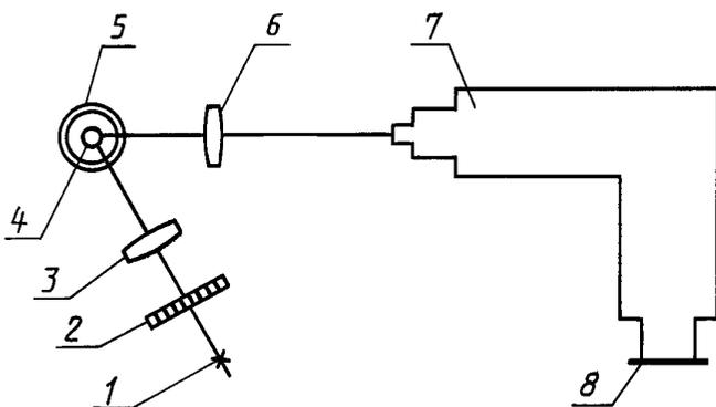
1 — источник возбуждения люминесценции; 2 — светофильтр; 3 — конденсор ( $F = 75-100$  мм); 4 — пробирка с экстрактом или раствором сравнения бенз- $\alpha$ -пирена; 5 — прозрачный сосуд Дьюара с жидким азотом; 6 — конденсор ( $F = 94$  мм), фокусирующий люминесцентное излучение на щель спектрографа; 7 — спектрограф с камерой ( $F = 120$  мм); 8 — кассета с фотопленкой
