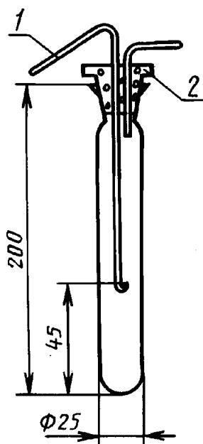
1 — трубка из нержавеющей стали по ГОСТ 5632—72 диаметром 3 мм; 2 — фторопласт
