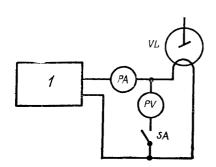
I — источник питания накала; PA — амперметр; PV — вольтметр; SA — выключатель; VL — рентгеновская трубка
