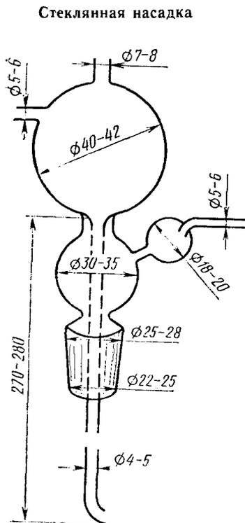
К боковой трубке насадки, спаянной с брызгоуловителем, присоединяют холодильник, конец которого погружен в приемник с 40 см<sup>3</sup> раствора серной кислоты и 2—3 каплями метилового красного.
