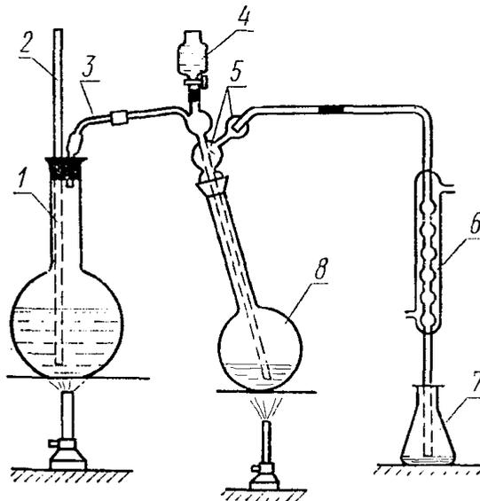
1—парообразователь; 2—предохранительная трубка; 3—брызгоуловитель; 4—капельная воронка; 5—стеклянная насадка, соединенная с колбой при помощи шлифа; 6—холодильник; 7—приемник; 8—перегонная колба.
