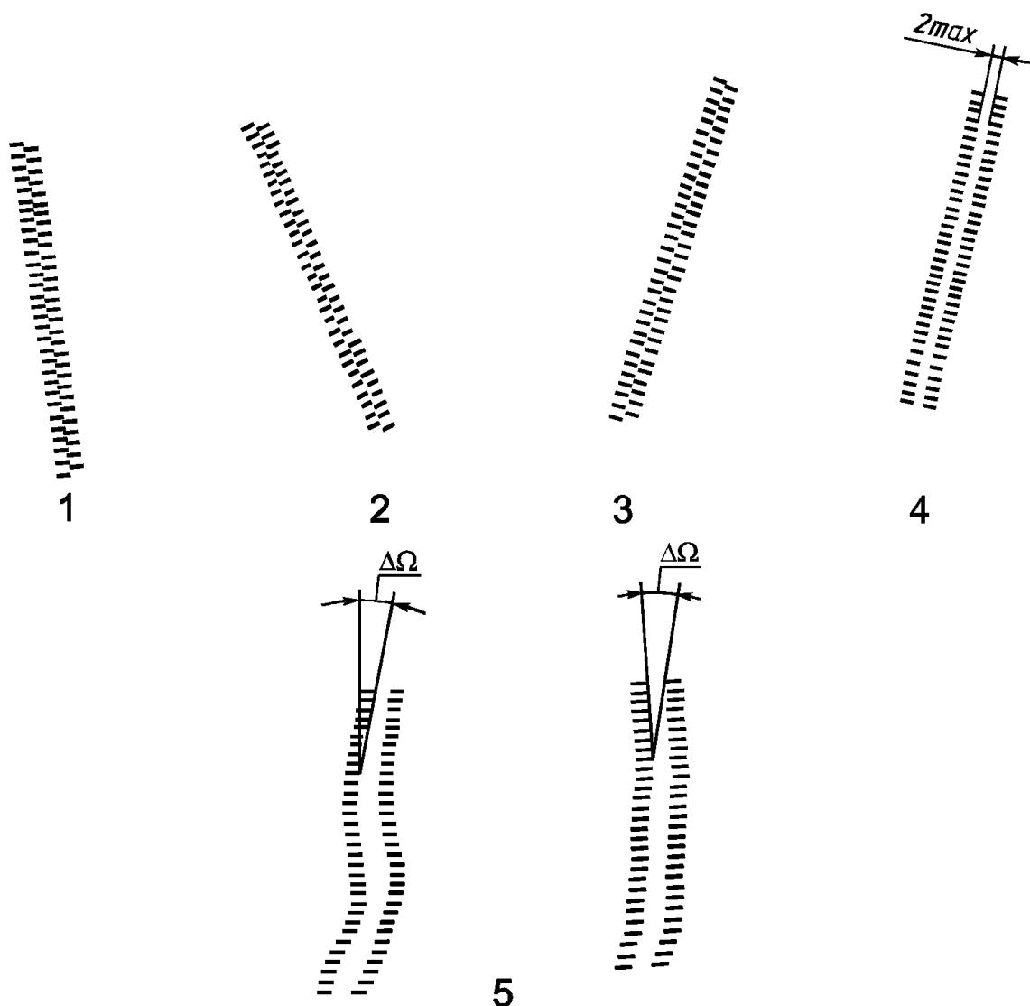
1, 2, 3 — отсутствие дефектов, 4 — импульсный камень смещен с линии центров «вилка — баланс» при нахождении системы «баланс — спираль» в положении статического равновесия; 5 — система «баланс — спираль» неизохронна, периодически меняется амплитуда колебаний баланса;  $\Delta\Omega$  — изменение суточного хода
