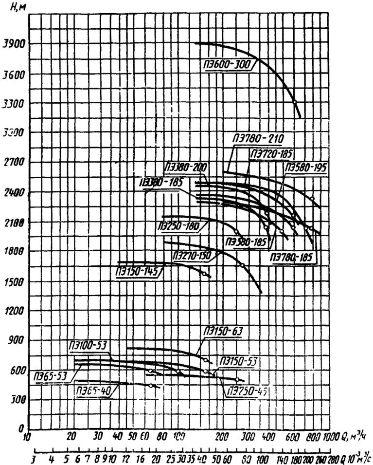
Пример условного обозначения изложить в новой редакции: «Пример условного обозначения центробежного питательного насоса ПЭ с подачей 0,105 м<sup>3</sup>/с (380 м<sup>3</sup>/ч) и давлением 18,1 МПа (185 кгс/см<sup>2</sup>): Насос ПЭ 380—185 ГОСТ 22337—77».
