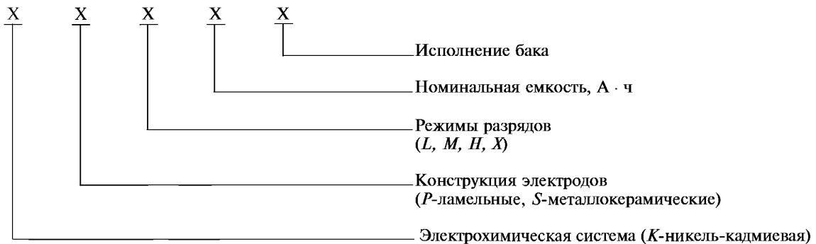
Пример условного обозначения аккумулятора никель-кадмииевой системы с ламельными электродами короткого режима разряда, емкостью 150 А · ч в пластмассовом баке.
