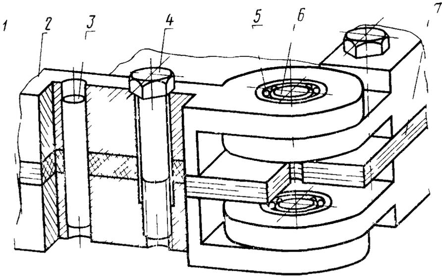
1, 2—четырёхзвенник 3—фиксатор; 4—болт 5—подшипник радиальный
