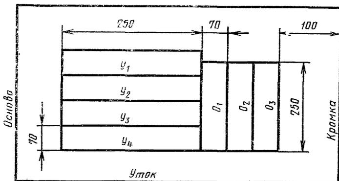
$U_1, U_2, U_3, U_4$  — заготовки уточных пробных полосок;  $O_1, O_2, O_3$  — заготовки основных пробных полосок
