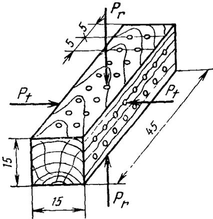
$P_r$  — действие нагрузки в радиальном направлении;  $P_t$  — действие нагрузки в тангентальном направлении
