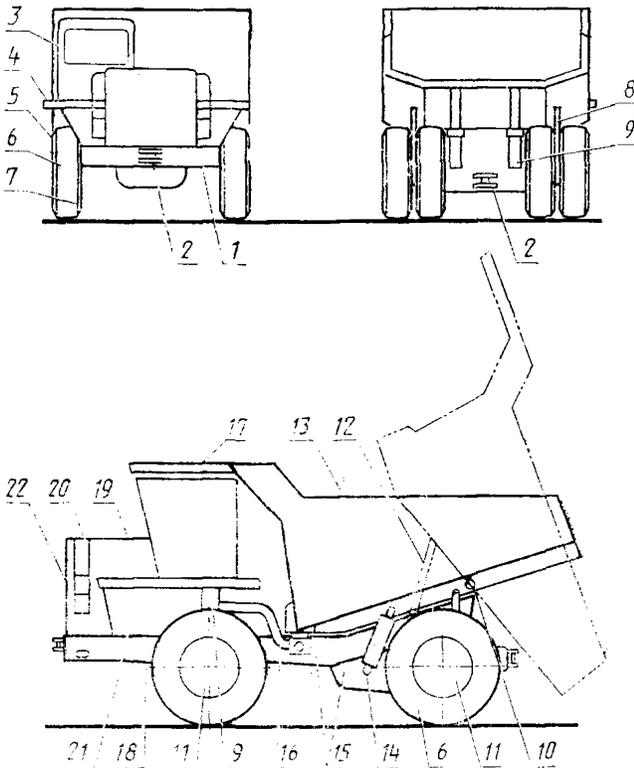
5.4.2. Наименования составных частей двух- и четырехколесного трактора (тягача): 1 — бампер; 2 — буксирный крюк; 3 — нижний защитный лист картера; 4 — основная рама; 5 — крыло; 6 — шкворень сцепного устройства; 7 — сцепное устройство; 8 — ось шарнира поперечного качания; 9 — серьга сцепного устройства; 10 — ось шарнира продольного качания
