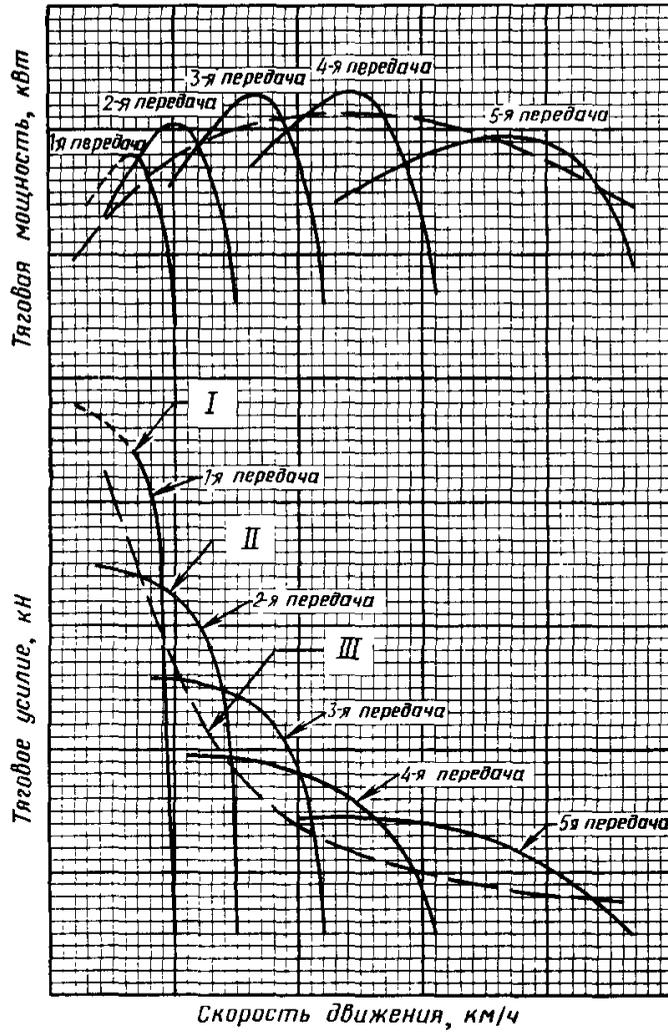
I — предельное буксование 15%; II — ступенчатая трансмиссия; III — бесступенчатая трансмиссия
