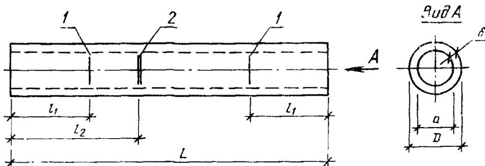
1 — место строповки при выемке из опалубки и транспортировании (одинарная полоса); 2 — место строповки при подъеме на копер (двойная полоса)
