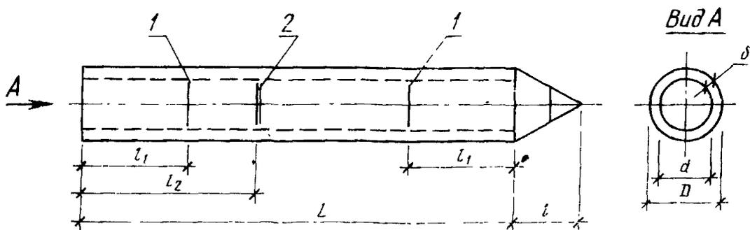
1 — место строповки при выемке из опалубки и транспортировании (одинарная полоса); 2 — место строповки при подъеме на копер (двойная полоса)
