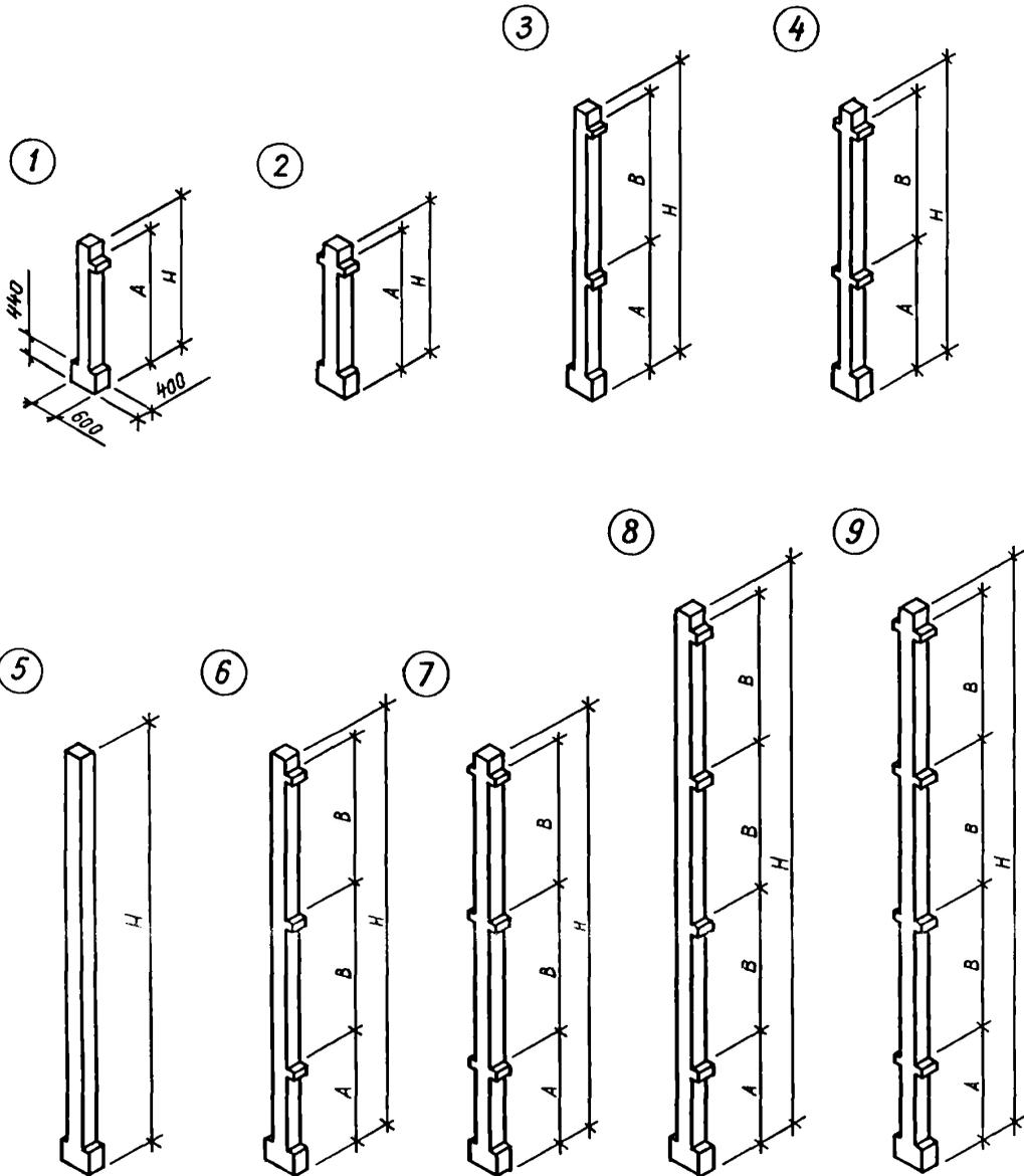
КОНСТРУКЦИИ КАРКАСА С КОЛОННАМИ СЕЧЕНИЕМ 400X400 мм
