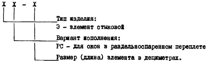
Пример условного обозначения стыкового элемента для окон в спаренном перешлесте длиной 12 дм:
